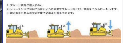
ブレードに負担がかからないように廃土 板を自動制御し敷き均しを行う。
