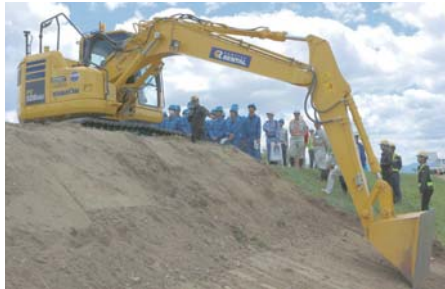
セミオート制御機能搭載油圧ショベルPC-200i-10による実演
