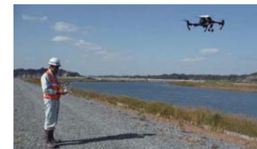
鳴瀬川中下地区背割堤(3工区)工事におけるドローンによる横断測量
